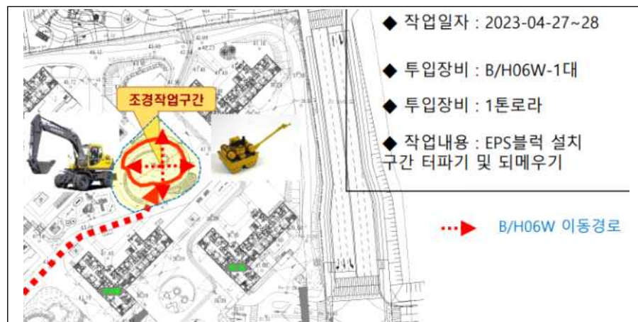
그림 5.1.19 EPS 블록 시공 시 투입된 장비 현황
